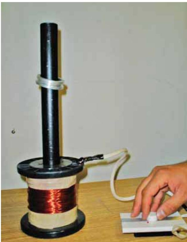
**Figura 2.** Electroimán para el experimento de levitación magnética.
