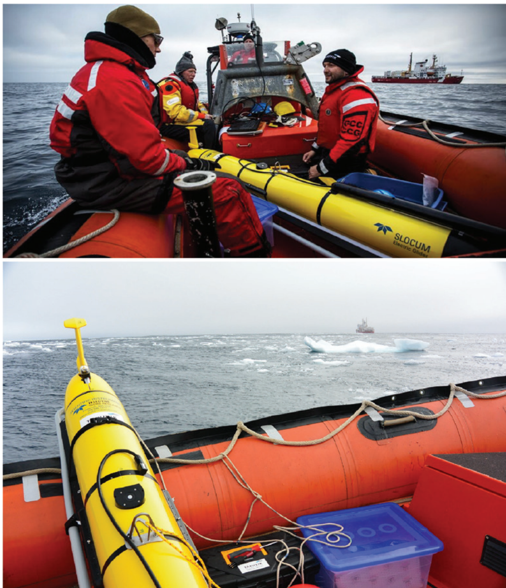
Figura 3. Operaciones de lanzamiento y recuperación de planeadores submarinos a bordo del rompehielos científico Amundsen, en la Bahía de Baffin, Canadá. Fuente: Laboratorio Takuvik.
