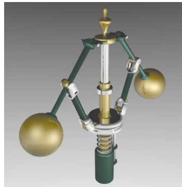
Figura 1. Péndulo centrífugo inventado por T. Mead y adaptado por J. Watt y M. Boulton.
