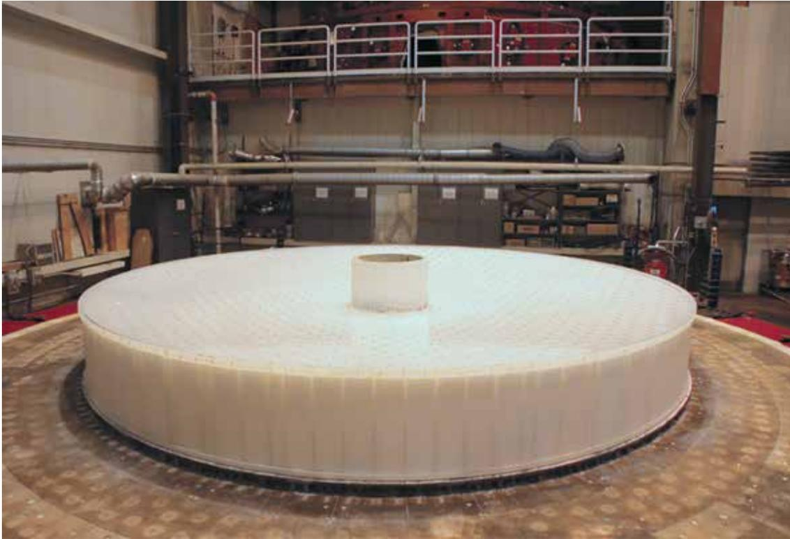
**Figura 2.** Espejo de 6.5 m del TSPM durante su fase de construcción en el Richard F. Caris Mirror Lab de la UA.
