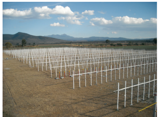
Figura 4. Antena del observatorio MEXART (Mexican Array Radiotelescope) en Coeneo, Michoacán, instrumento principal del Laboratorio Nacional de Clima Espacial.
