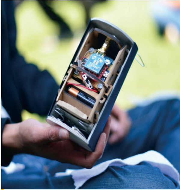
Figura 2. Satélite enlatado (CanSat). Imagen del concurso CanSat 2018-2019.
