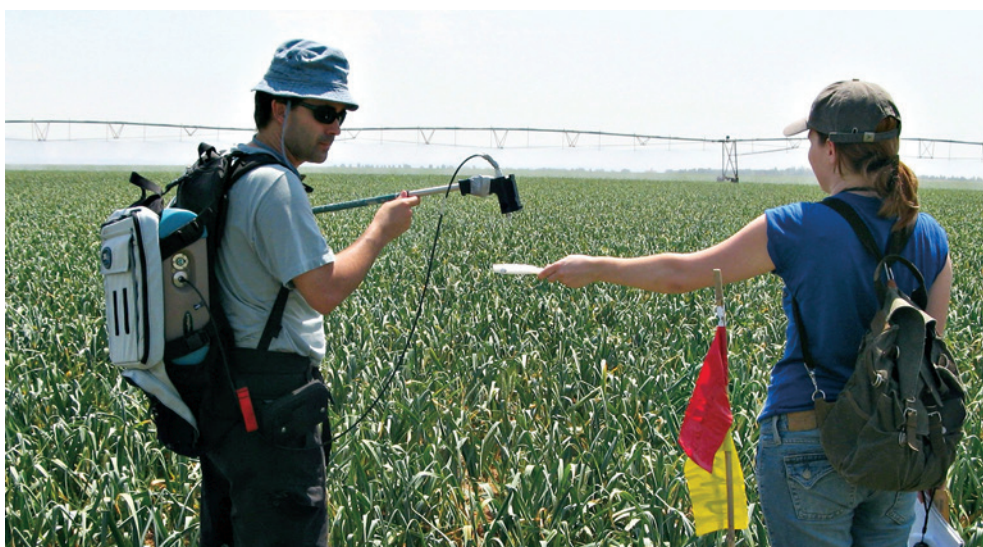
Figura 6. Medición de las firmas espectrales de un cultivo. El espectrorradiómetro está sobre la espalda del hombre, que también está sujetando el cabezal de medición que se conecta al equipo mediante una fibra óptica. La joven está sujetando un material de alta reflexión para calibrar el equipo, previo a las mediciones de las firmas espectrales de la plantación. Fuente de la imagen: página web de la Secretaría de Agricultura y Desarrollo Rural, Gobierno de México.
