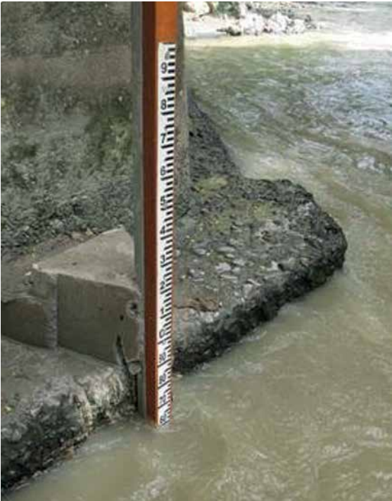
Medidor de nivel de agua. Tomada de: https://www.gob.mx/conagua/articulos/sabes-que-es-una-estacionhidrometrica .
